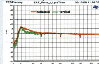
Obwohl im Forte-Ikeda-Tonarm die Tiefenresonanz bei nur 5 Hz liegt, klingt die Kombination mit dem Lyra Titan i sehr gut, zumal er die Resonanz gut bedämpft.
